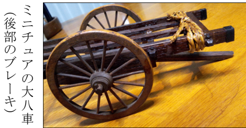
大八車の大きさ 長さ 約3.6m 巾（車軸部分）1.2m 荷台部分1.8m×0.7m 車輪の直径 96cm
