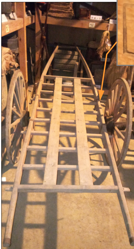
大八車の大きさ 長さ 約3.6m 巾（車軸部分）1.2m 荷台部分1.8m×0.7m 車輪の直径 96cm
